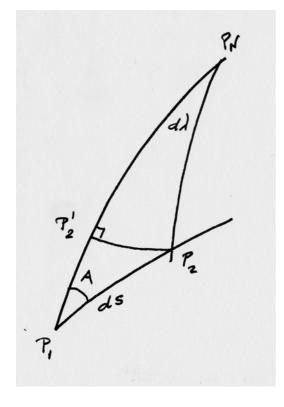
Si consideramos un arco elemental de geodésica P<sub>1</sub> P<sub>2</sub>. Si ds es su longitud y P<sub>2</sub> P'<sub>2</sub> es el arco de paralelo que contiene a P<sub>2</sub> y A es el acimut de la geodésica en P1. El triángulo elemental P<sub>1</sub> P<sub>2</sub> P'<sub>2</sub> puede considerarse plano y escribir:
